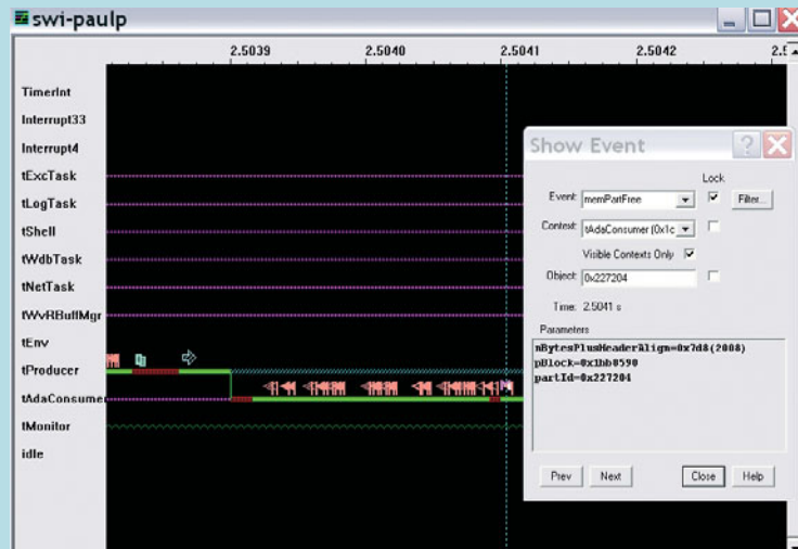
Abb. 2: Der Wind River System Viewer zeigt den Ada-Aufruf der VxWorks C API
